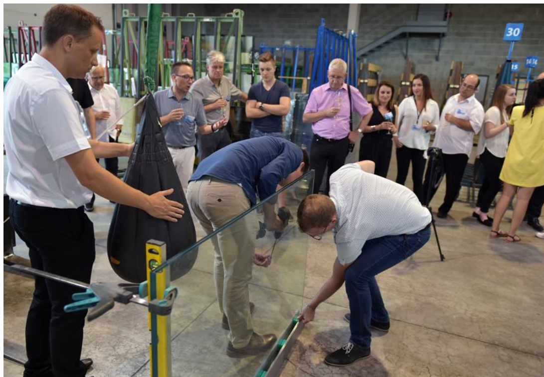
Sous l'impact du sac de sable de 50 kg, le verre s'est courbé sans se briser pas ni s'étoiler. Ce test technique souligne la résistante du verre feuilleté qui peut aussi être décoré. Photo Pierre MATHIS
